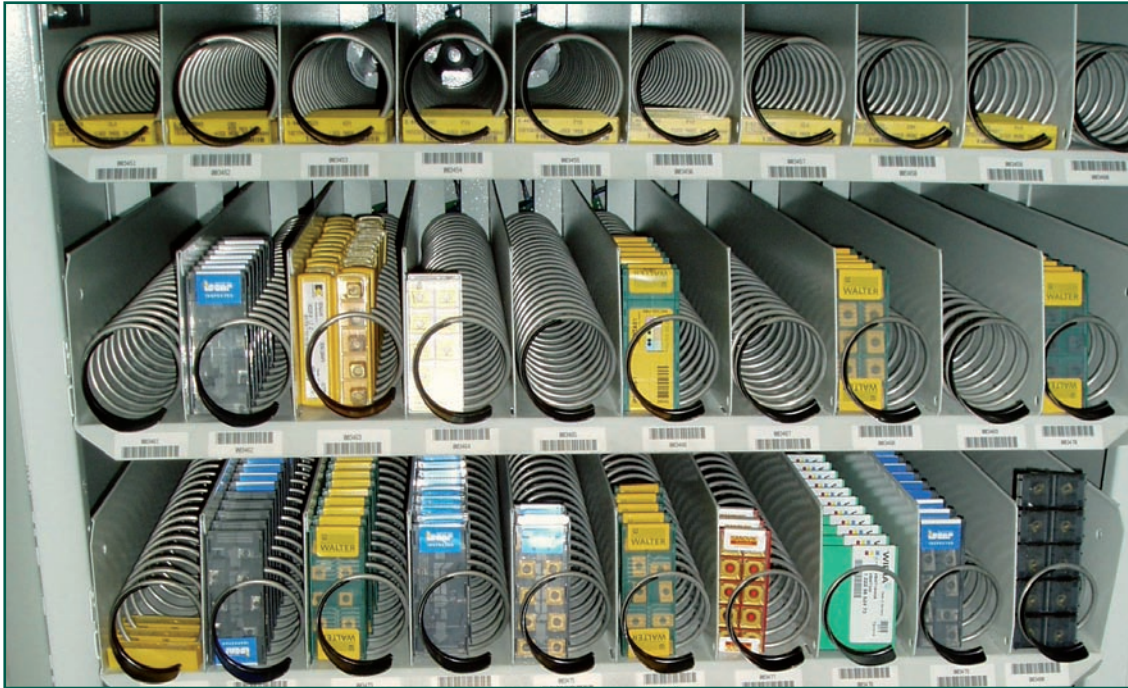
Ausgabeschächte eines KROMI Tool Centers (KTC)
